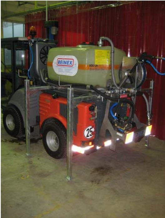
**6. Abstellstützen gleichmäßig absenken, bis alle vier Füße der Stützen in der Luft hängen**
